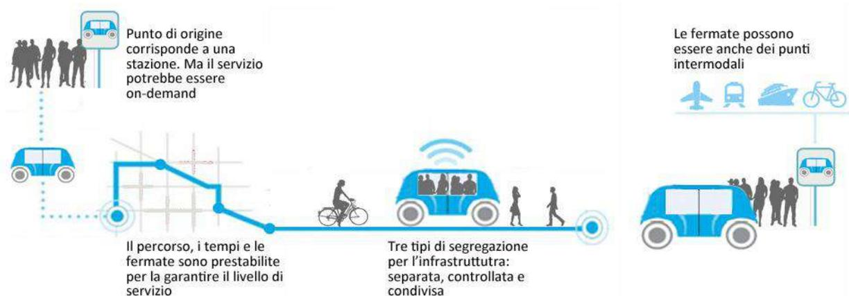
Figura 105 - Il meccanismo di azione di un sistema a guida autonoma per il trasporto pubblico collettivo
